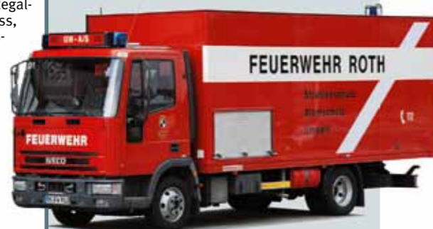
Die Feuerwehr Roth baute einen Iveco 75 E 14 mit Kofferaufbau zu einem GW-A/S um.
