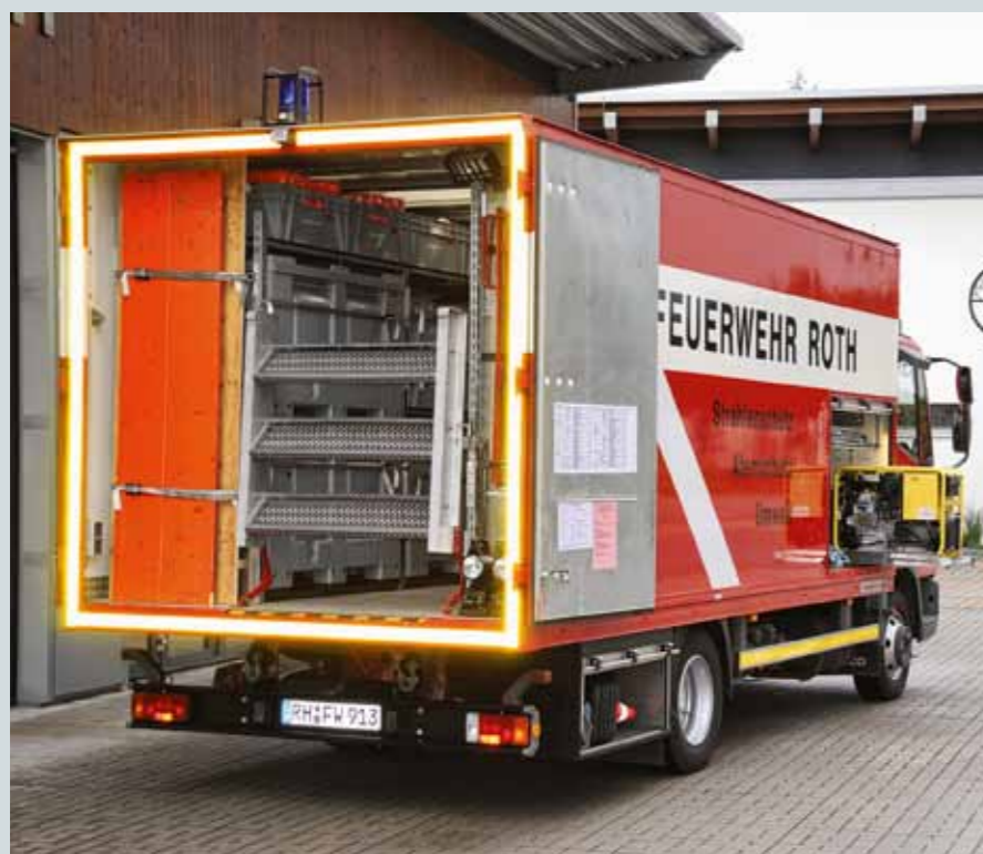
Der Zugang in den Gerätekoffer des Gerätewagen-Atemschutz/Strahlenschutz (GW-A/S) der Feuerwehr Roth erfolgt vom Heck aus. Hinter den normalen Türen ist eine ausklappbare Treppe montiert. Gut zu erkennen ist die nachträglich angebrachte reflektierende Konturmarkierung.
