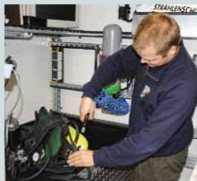
Für kleine Reparaturen steht ein Arbeitsplatz zur Verfügung. Michael Hofmann säubert mit der Druckluftpistole ein Atemschutzgerät.
