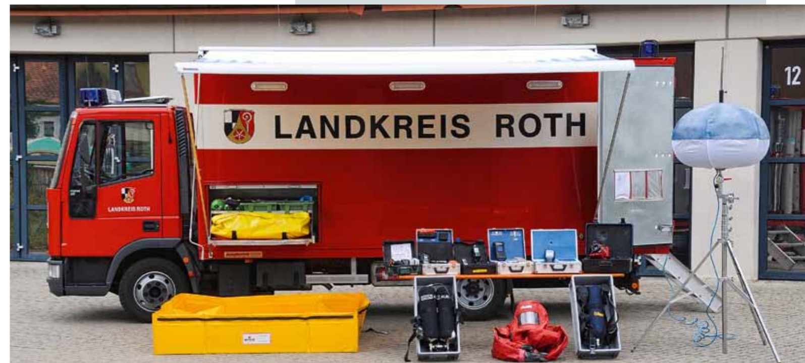
Neben 22 Pressluftatmern und 46 Reserveflaschen werden im GW-A des Landkreises Roth ein Powermoon-Leuchtbalken, einige Messgeräte sowie weitere Gefahrgutkomponenten mitgeführt.
