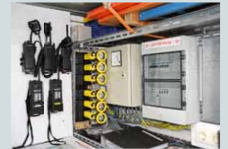
Im Innenraum auf der rechten Seite befindet sich die „Schaltzentrale“ des GW-A. An der Stirnseite sind sechs Ladehalterungen für Handlampen und fünf für Handsprechgeräte montiert.
